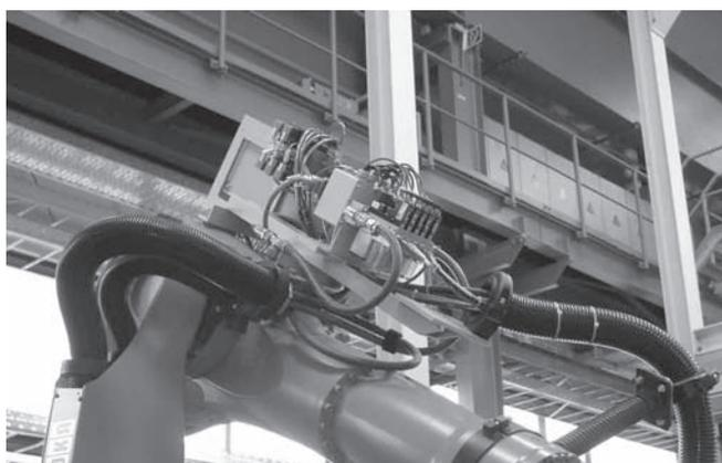
Вакуумный генератор, состоящий из пяти компактных эжекторов SMP, на руке робота
