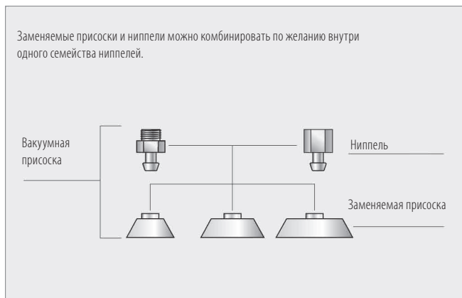
Модульная конструкция вакуумной присоски
