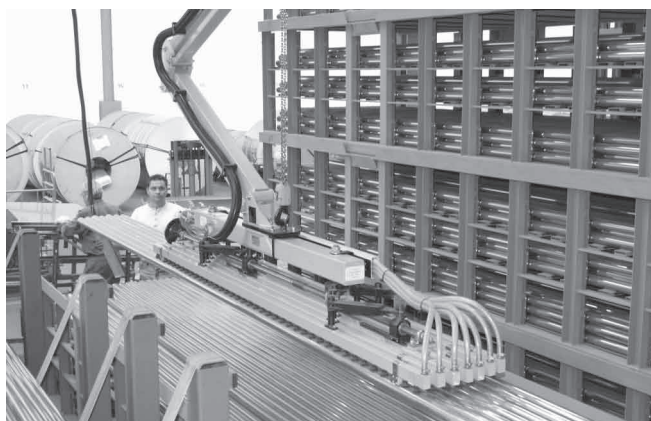
Манипулирование трубами с помощью адаптируемых вакуумных присосок FSG и FSGB
