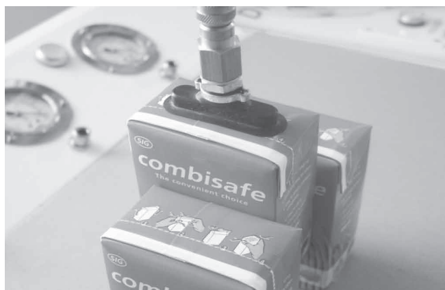
Плоские вакуумные присоски SGON обеспечивают максимальную подъемную силу при меньших размерах
