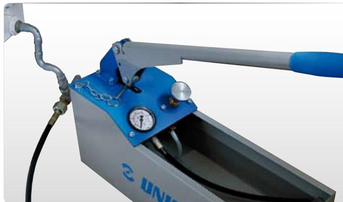
Высококачественный насос-манометр УНИОР (UNIOR) спроектирован для проверки герметичности трубопроводных сетей отопления. Давление в системе регулируется ручным рычагом. Как только рычаг поднимается до максимально достижимого положения при нагнетании (наибольший объем жидкости), давление в системе снижается. Требуемое давление достигается небольшими движениями рычага благодаря повышению давления в системе. Из-за этой особенности давление в системе может быть выставлено с высокой точностью.
