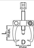
**683** СЪЁМНИК С ДВУМЯ ПЕРЕМЕЩАЮЩИМИСЯ ЗАХВАТАМИ
