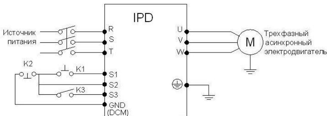
(2) Настройка параметра PF33 определяющего направления вращения
