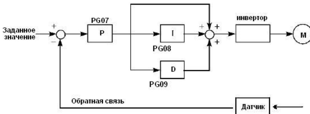
Замечания по использованию преобразователя в режиме PID-регулирования:
