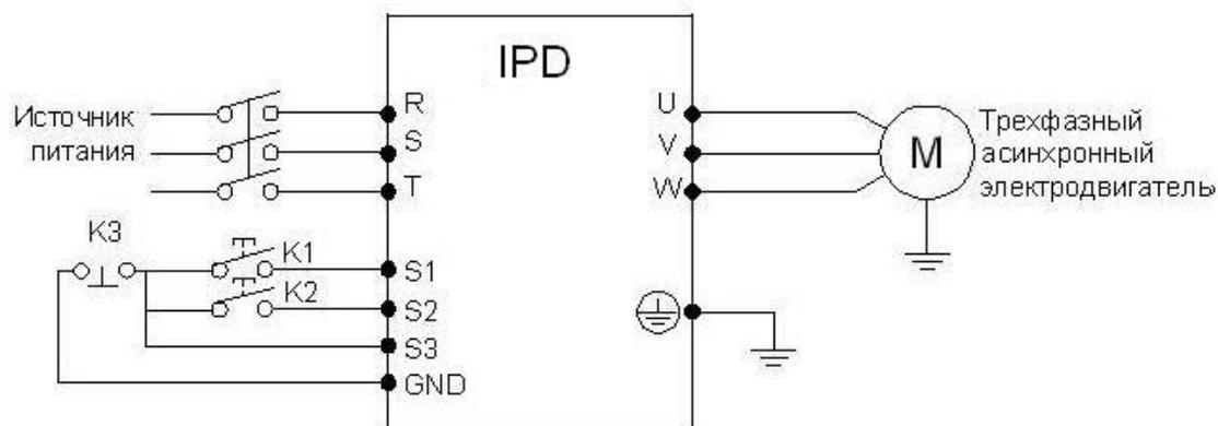
В качестве входов для внешнего сигнала здесь используются K1, K2, и K3. Контакт K3 нормально замкнутый.
