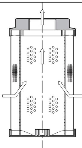
— Фильтры FSI являются фильтрующими элементами, которые работают в условиях полного погружения в резервуар. Они устанавливаются непосредственно у окончания всасывающего трубопровода насоса.
