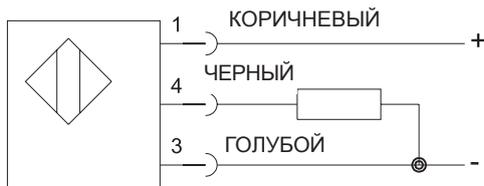
обесточенный клапан = замкнутые контакты=светодиод вкл.
