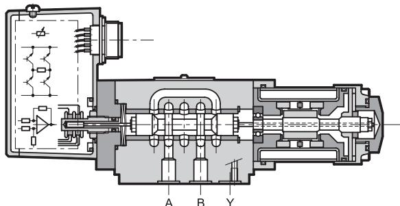
— Клапан DXJ5 представляет собой четырехлинейный пропорциональный сервоклапан и золотником, перемещающимся в специальной гильзе. Клапан имеет прямой линейный электропривод, обеспечивающий высокую динамическую характеристику вне зависимости от давления в системе. Положение золотника контролируется линейным датчиком (типа LVTD) с обратной связью, обеспечивающим высокую точность и воспроизводимость.
