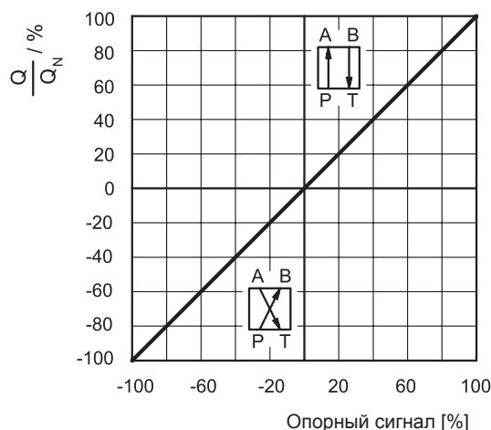
Типовые кривые зависимости величины расхода от опорного сигнала при постоянном D p 70 бар Р-Т.
