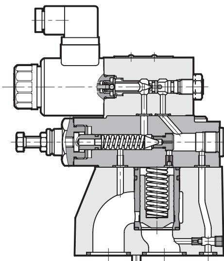
— Клапан PRE\* представляет собой перепускной предохранительный клапан с пилотным пропорциональным электронным управлением и монтажной поверхностью в соответствии со стандартом ISO 6264 (СЕТОР RP 121H).
