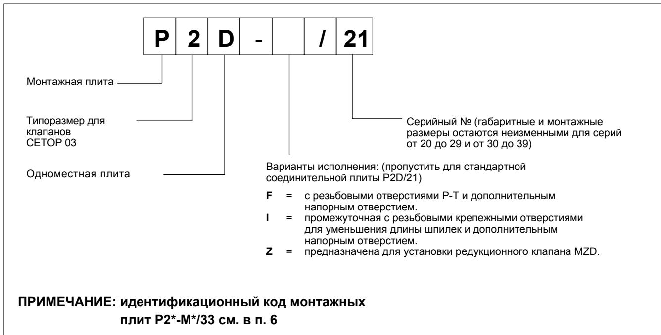
**2 - ГАБАРИТНЫЕ И МОНТАЖНЫЕ РАЗМЕРЫ P2D/21 (код 15600121)**
