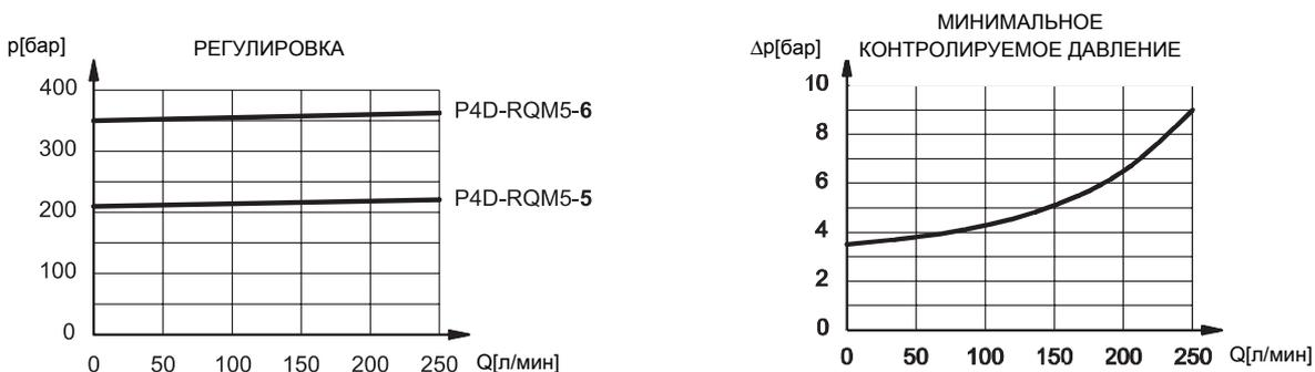
**ПРИМЕЧАНИЕ:** Максимальный расход 150 л/мин соответствует максимальному номинальному расходу в отверстии P 1/2" BSP (через монтажную поверхность для соединительных плит P2D и P4D).
