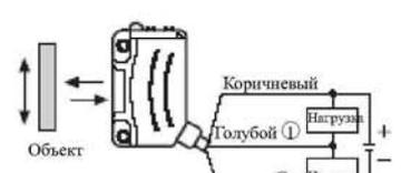
\*①: Нагрузка подсоединена к выходу NPN с открытым коллектором
