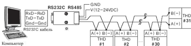
\* Должен быть использован SCM-38I (Autonics) для преобразования RS 232 в RS 485.
