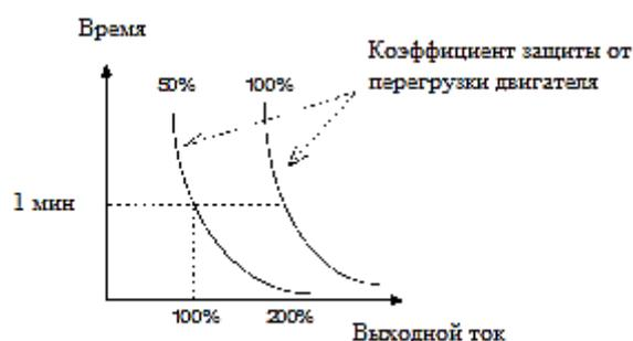
Рис. 6-27 Кривая защиты двигателя от перегрузки
