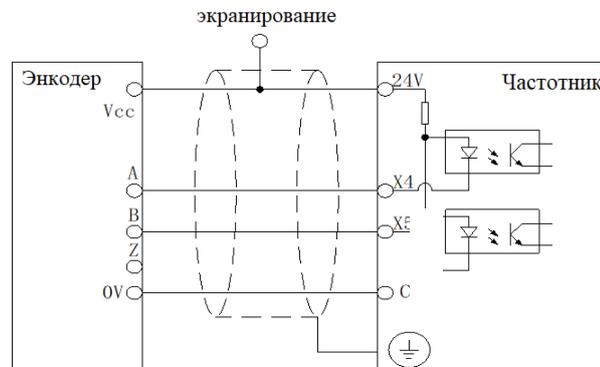
Вышеуказанная схема – это способ подключения энкодера для двухтактного (Pull-Push) выхода или выхода по напряжению. Напряжение питания энкодера 24 В, а рекомендуемое питание для входной оптопары преобразователя 24 В.
