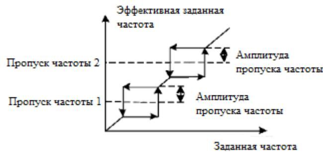
Рис. 6-5 Пропуск частот
