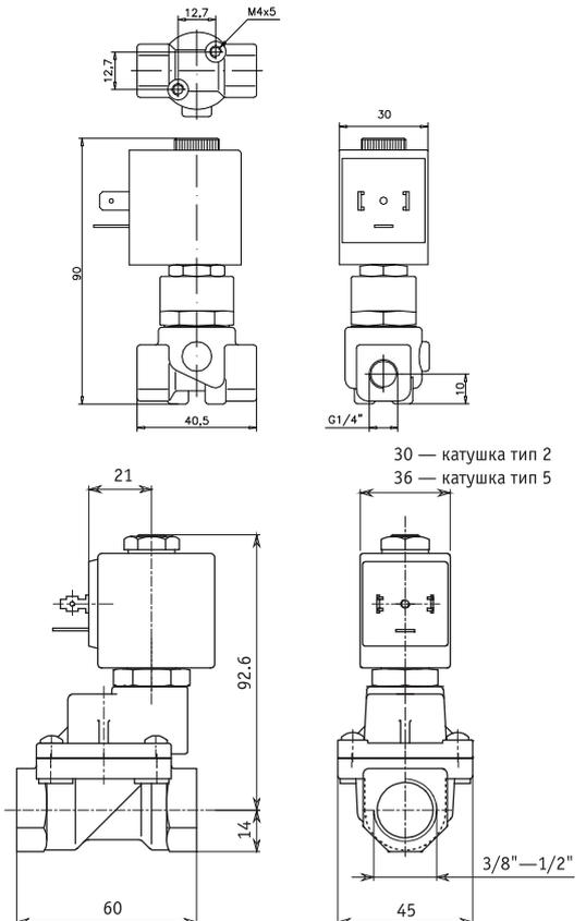
**Тип 219 - 2/2 нормально закрытый клапан с сервоуправляемым поршнем**
