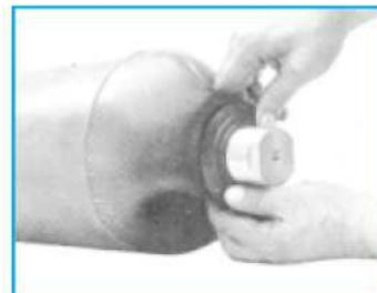
ТАРЕЛЬЧАТЫЙ КЛАПАН скользит свободно, пружина не повреждена и самозапирающая гайка, фиксирующая задерживающий переводной ниппель затянута осторожно. ПРОКЛАДКИ И УПЛОТНИТЕЛИ не изношены. ВНУТРЕННЯЯ ПОВЕРХНОСТЬ корпуса аккумулятора без трещин и следов повреждений
