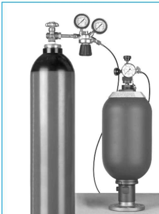
**ОБРАТИТЕ ВНИМАНИЕ:** Устройство предварительной загрузки PC250 поставляется с одним манометром 0 ч 250 бар. Конечно, для измерения давления выше, чем 250 бар, необходимо задействовать подходящий полномасштабный манометр. Также при низком давлении точность измерения будет выше, при использовании подходящего манометра: например при давлении ≤ 30 бар, желательно использовать полную шкалу 60 бар.
