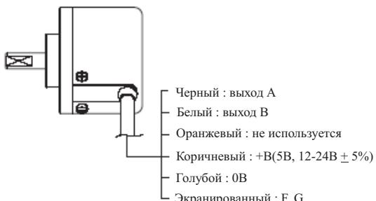
\* Неиспользуемые провода должны быть изолированы.
