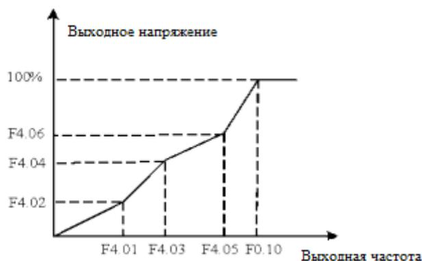
Рис.6-9 Кривая зависимости напряжения от частоты, определяемая пользователем
