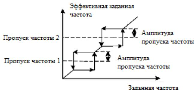
Рис. 6-5 Пропуск частот
