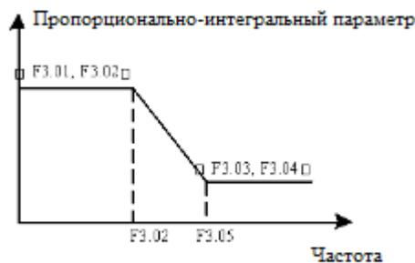
Рис. 6-7 Схема пропорционально-интегральных параметров контура скорости
