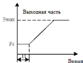
Рис.6-3 Пусковая частота и время выдержки пусковой частоты
