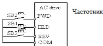
Рис.6-15 Трехпроводной режим управления 1
