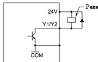
Рис. 3-12 Способ подключения внутреннего источника питания +24 В
