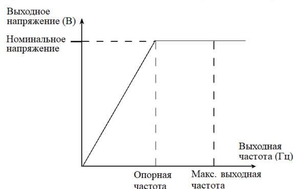
Рис. 6-1 Типичная схема отношения напряжения и частоты
