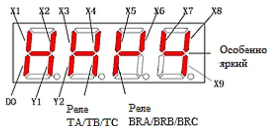
Рис. 6-28 Схема отображения текущего состояния статуса клемм
