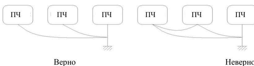
Рис. 3-5 Заземление
